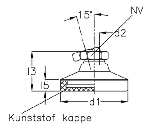
d1 = 25 d2 = 8 l3 = l5 = -NV = 12 Static load (N) = 7 t min = 9
